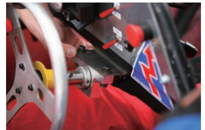
ステアリングシャフトを受けるボスとフレームを接合する金属板の強度が足りないため、ステアリング操作をすることでこの部分がしなっていた。強度不足への対応を指摘された。
