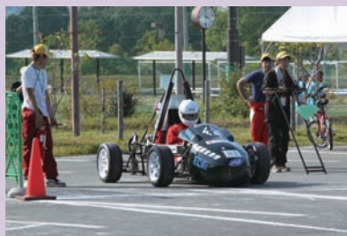
↑ブレーキテストでクラッチミートがうまくいかず、何度かやり直しになった。その振動でフロントカウルのスターが折れ、すでに地面に接触してしまっている。
