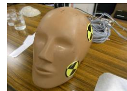
左写真の代替脳がダミーに 装備される。頭部の頭頂落 下／側突実験・回転衝撃試 験後の、脳の部位ごとのカ ルシウムイオン検出量の測 定結果を報告、この評価手 法の有効性が示された。
