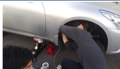
ロアアームへのセンサー設置
