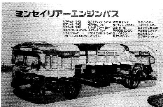
図6 我国最初のモノコックバスBR30型(1949年)
