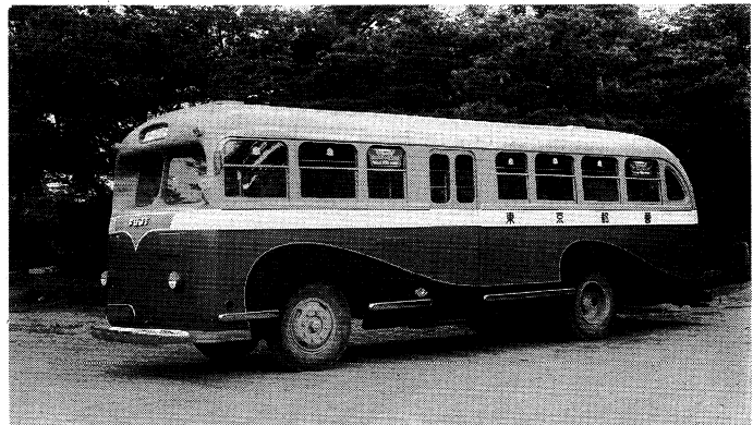
フレームレス・モノコック・リヤエンジンバス“富士号” 昭.24
