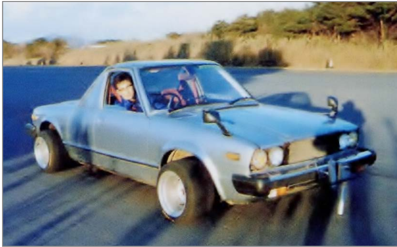
図16 自動車前部を背中合わせで繋いだ4WSの実験車 (ドライバは佐野氏)
