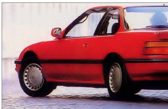
図18 世界初の4WS市販乗用車(1987年) ※後輪も操舵されている状態
