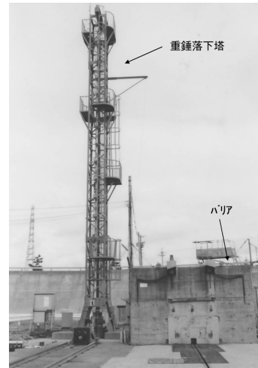
〈旧衝突試験場の重錘落下塔〉 当時、古庄氏が考案された 衝突試験車牽引システム
