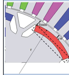
Figure 6-9 磁石の曲率半径に関するモデル
