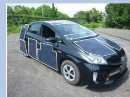
Figure 6-25 ソーラモジュールの搭載状況
