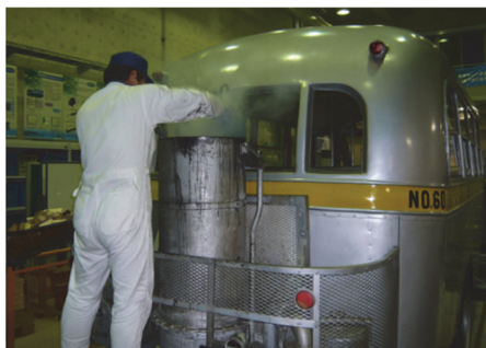
Fig. 4 ガスを発生させる作業風景
