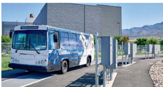
Fig 9 Utah 州立大学の走行中給電バス
