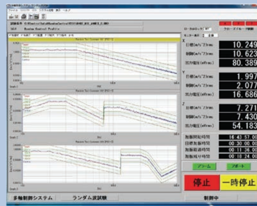
Figure 7-7 米国フリーウェイでの 3 軸ランダムプロファイルによる実波形 PSD ランダム振動データ
