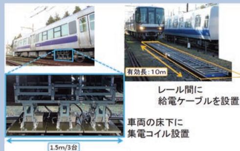
Figure 5-22 構内試験線での試験状況
