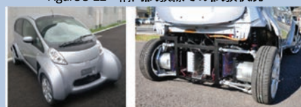
Figure 5-23 ワイヤレスインホイールモータ搭載 EV
