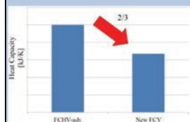
Figure 5-32 新モデルと旧モデルのスタックの熱容量
