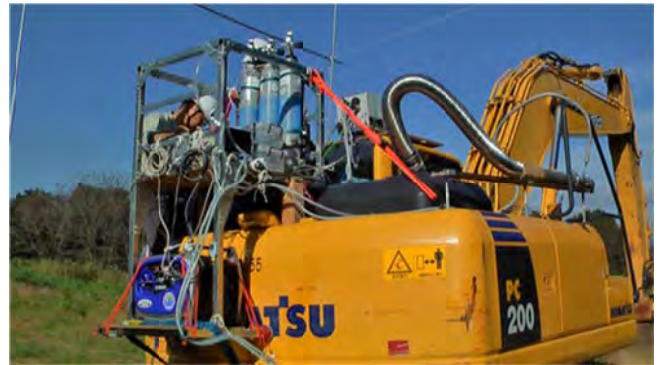
図3 車載型排出ガス計測装置搭載状況(2)
