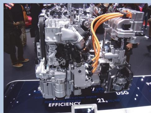
Figure 1-5 twin up!のハイブリッドモジュール
