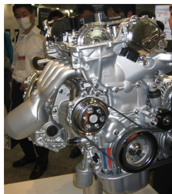
Figure 2-2 マツダの次期デモ用「SKYACTIV-G 1.3」エンジンカットモデル
