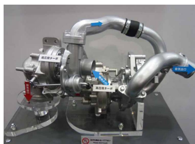
Figure 3-1 4HK-1エンジン向け2ステージターボチャージングシステム
