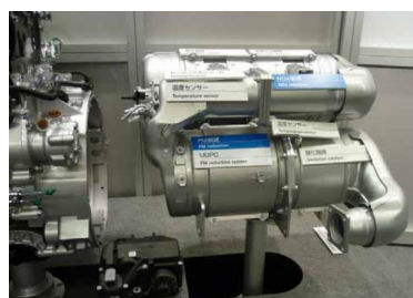
Figure 4-2 コンパクト化されたPMフィルタ+脱硝装置
