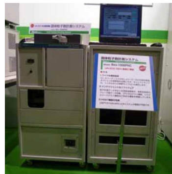
Figure 5-1 PM 粒子数の計測装置 (写真は車載タイプではない)
