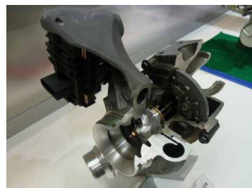
Figure 4-1 電子制御アクチュエータ付きVGターボチャージャ
