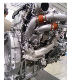
Figure 3-2 4JJ1 2ステージターボチャージングシステムエンジン
